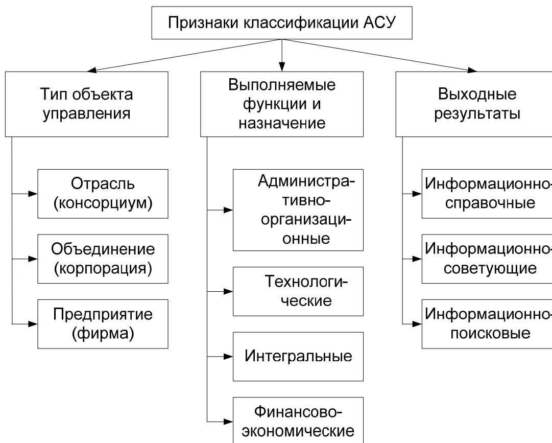
Рис. 2. Классификация автоматизированных систем управления
